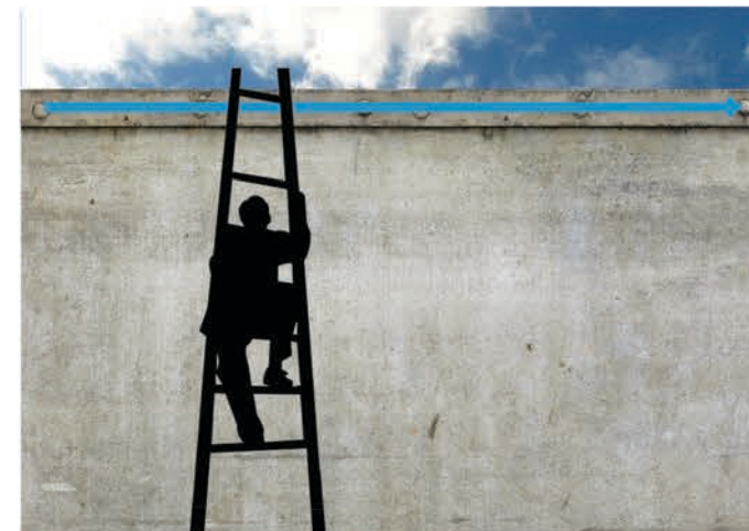
将梯子靠在墙壁边缘上，人体压在梯子上的重量将对 uPVC/PC 板施加作用。
